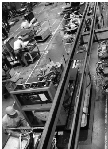
↑ オイルフェンス一体型の可搬形エンジン発電機 ← 一本の組立ラインで連番順に一個ずつ生産する本社工場の混流生産システム
