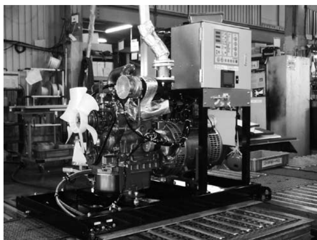
完成した発電装置
