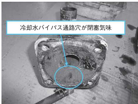
写真8 オイルクーラカバー内部
