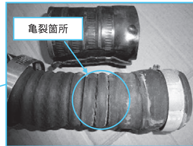
写真7 冷却水ゴムパイプ亀裂
