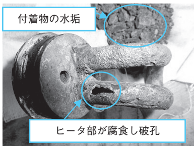
写真9 冷却水ヒータ損傷
