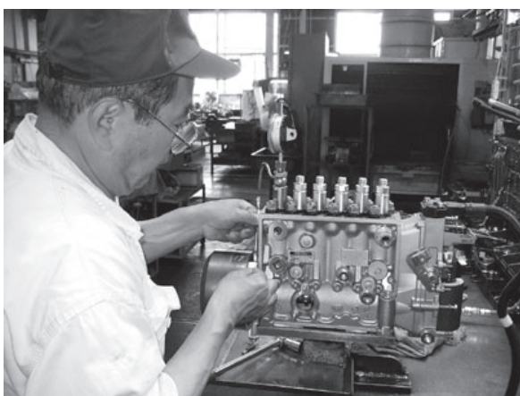
噴射ポンプの組立作業
