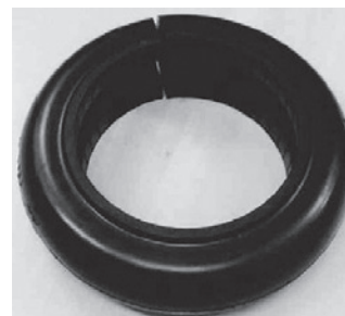
写真8：継手緩衝ゴム (新品：比較のため例示)
