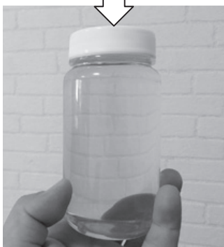
④経年劣化した自家発の燃料 ⑤独自のクリーニング技術で再生した燃料
