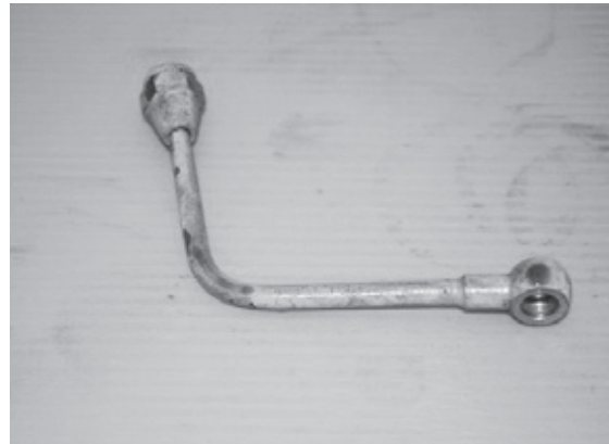
写真33：オイルパイプの発錆・汚損
