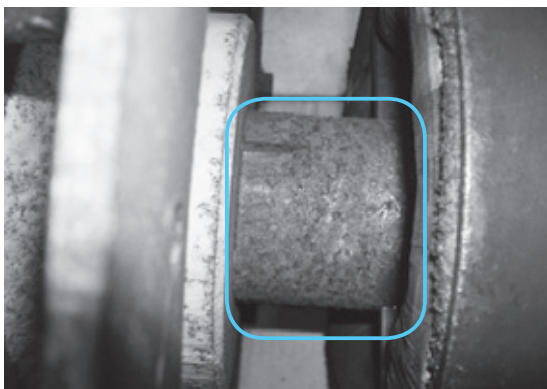
写真17：回転子軸の発錆
