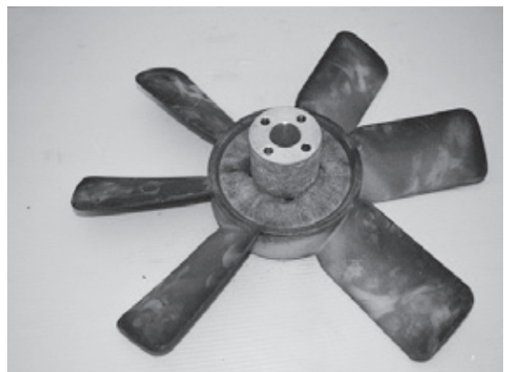
写真30：ラジエータファンの汚損
