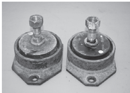
写真5：発電機側防振ゴム
