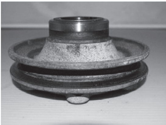
写真27：クランクプーリの発錆
