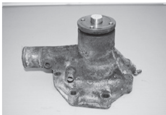
写真13：ウォーターポンプ外観の発錆
