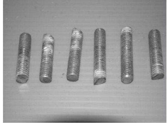
写真7：アンカーボルトの発錆
