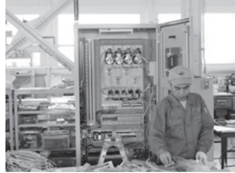
盤の部品組み付け配線
