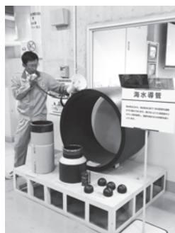
海水管は高密度ポリエチレン管を採用した
