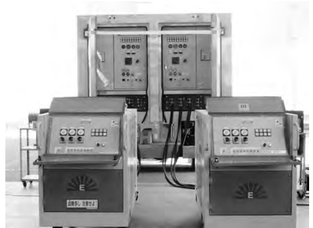
レンタル用(販売可能)ASL400型負荷試験器 ・400kW型負荷試験器 ・低騒音仕様
