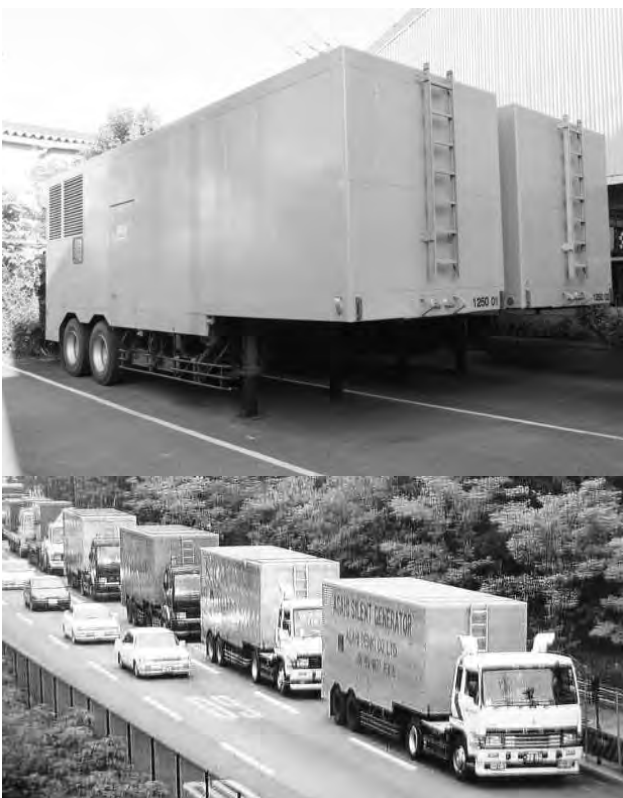
レンタル用トレーラー型電源車（上）、移動風景（下） ・1,250kVA発電装置搭載 ・並列自動同期投入装置付き
