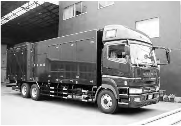
ACG-500DNA2型電源車（2013年販売） ・500kVA×2台(合計1,000kVA) 発電装置搭載 ・並列自動同期投入装置付き ・モノコック型軽量アルミフレーム仕様 ・低騒音2重防音フレーム構造
