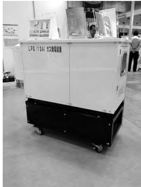
小型LPガスエンジン発電設備「LPG-G5000S」
