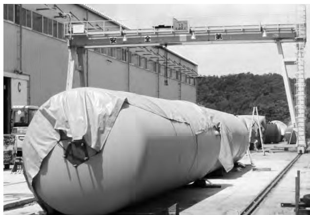
出荷を待つ「地下タンク」
