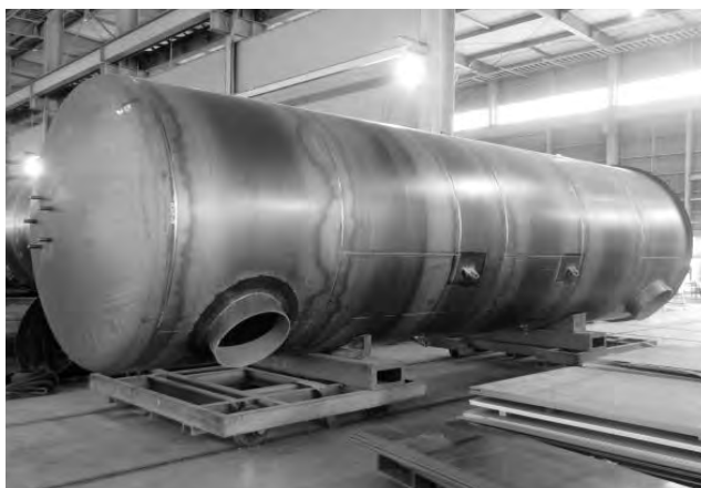
溶接による組立作業を終えた円筒形の地下タンク
