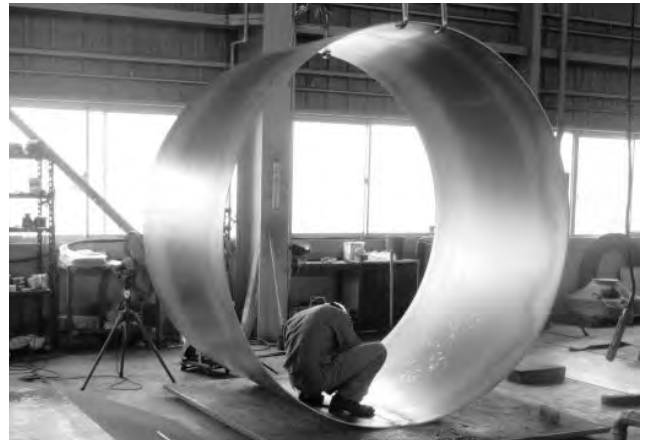
スチール鋼板を円形にする曲げ加工作業
