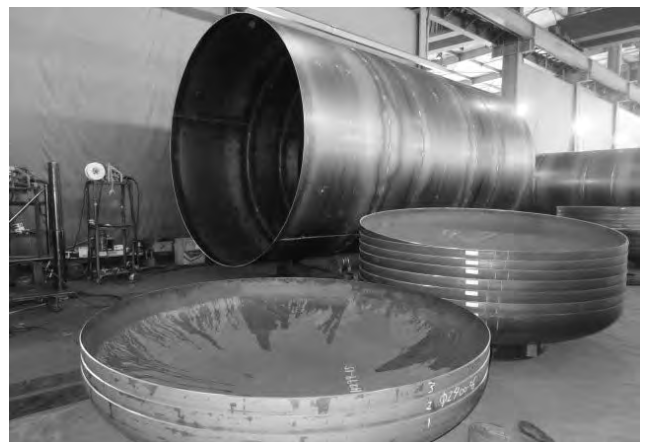
手前はタンクの両端に取り付けられるフタの鋼板（鏡板）
