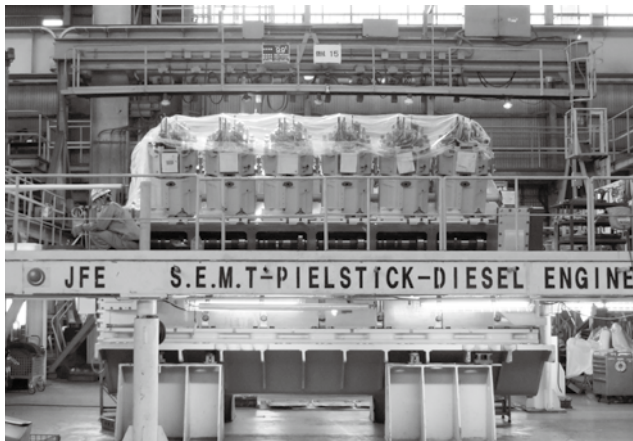
組立中の大型船用ディーゼルエンジン
