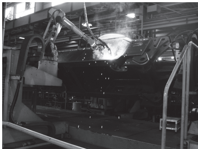
ロボットによるメインフレームの自動溶接作業
