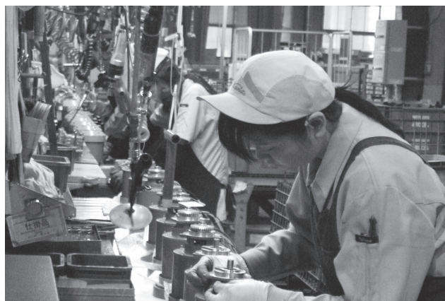
小型家庭用ポンプの組立ライン
