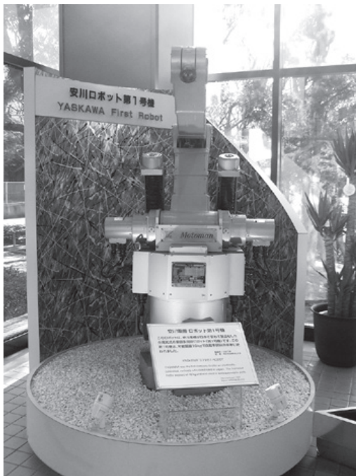
工場に展示している産業用ロボット1号機 「MOTOMAN(モートマン)-L10」
