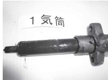
写真12 燃料噴射弁ホルダー 外周が腐食し外せない 状態にあった(#1気筒)
