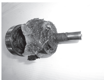
写真13 冷却水ポンプ ベアリング グリースに固化有り
