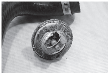
写真11 温調弁 多量の堆積物 が付着
