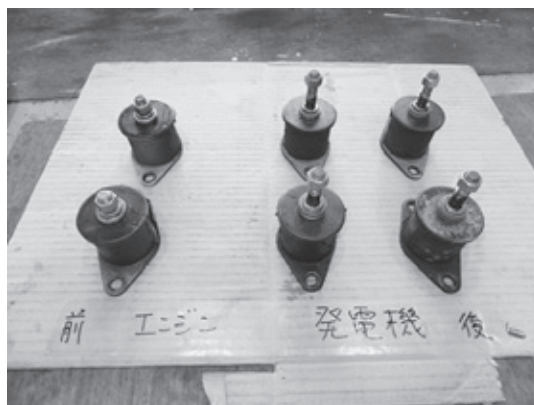
写真5：防振ゴムの硬化及びボルト発錆
