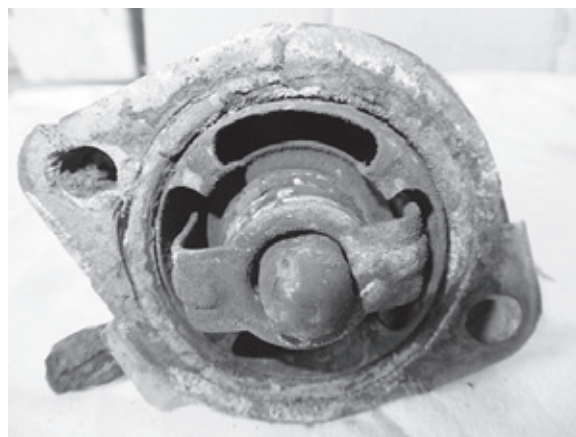
写真7：サーモスタットの腐食
