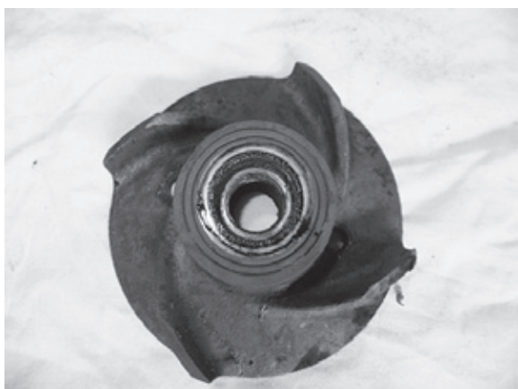
写真8：ウォーターポンプインペラの腐食
