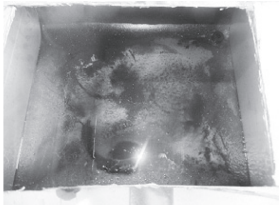
写真22：切開した燃料容器の内部
