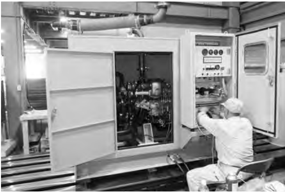
非常動力装置認証用の製作中(100kW超500kW未満)
