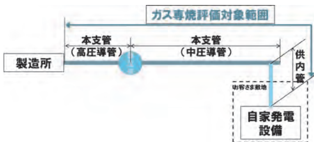
図1 本支管／供内管の概念図
