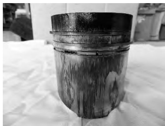
写真2 ピストンの摺動面スカッフ
