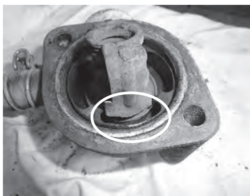
写真1 冷却水温調弁の破損(エレメントホルダ)
