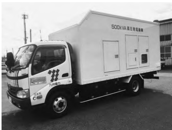
同社製発電設備搭載の高圧移動電源車
