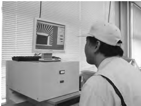
静岡工場 電子機器 基板のX線検査
