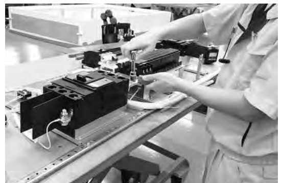
静岡工場 配電盤 組み立て
