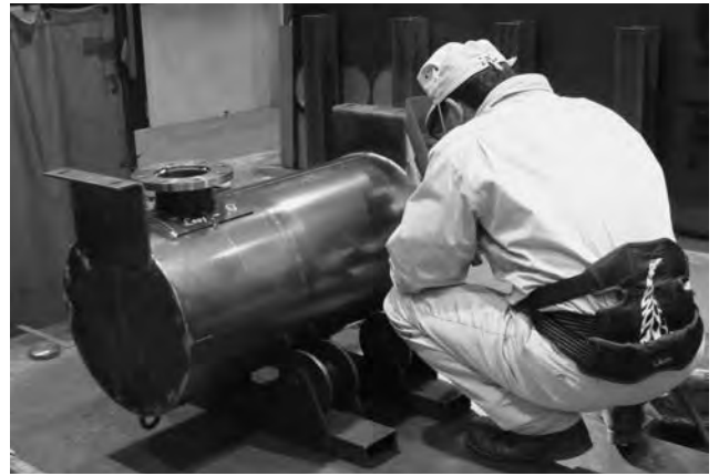
サイレンサー溶接作業
