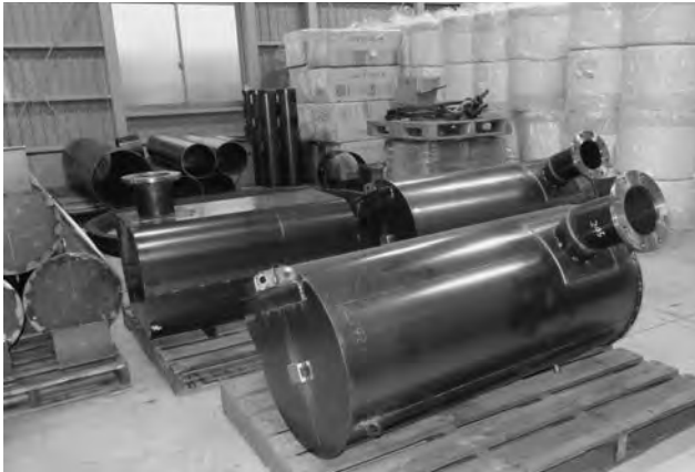
サイレンサー組立終了
