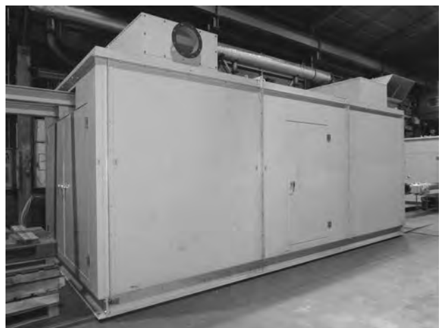
消音器開発試験用防音設備
