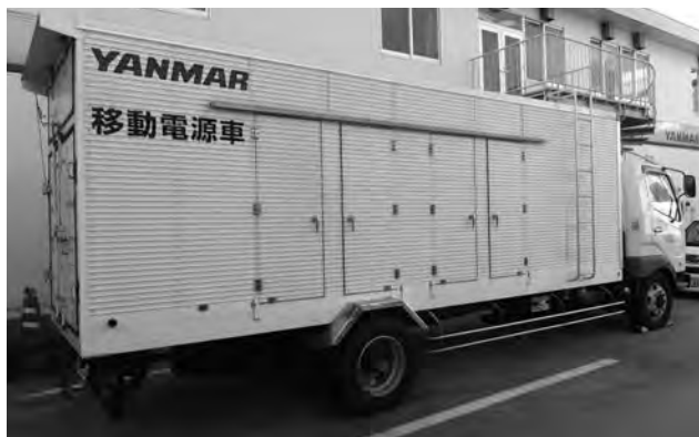
施設の停電作業で活躍する高圧移動電源車（500kW）
