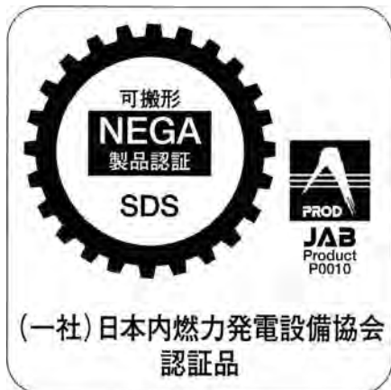
図7 可搬形発電設備適合マークの例 (SDSは出力10kW以上100kW以下。出力100kW超の表示はMDS。)
