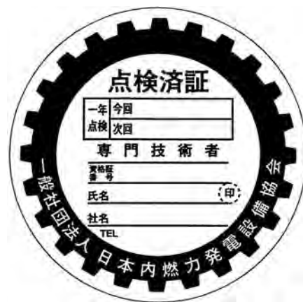
図8 可搬形発電設備点検済証の例
