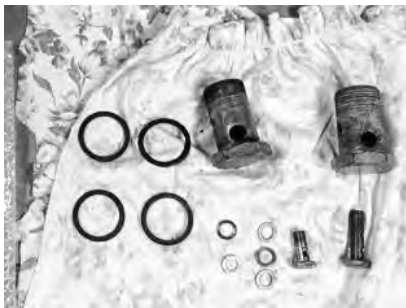
空気管の部品類の発錆
