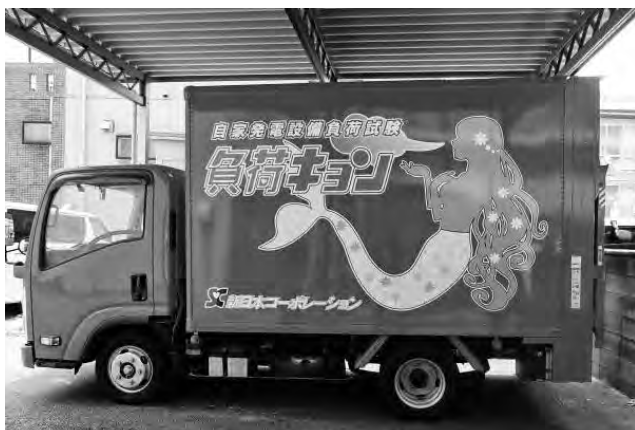
自家発電設備負荷試験車『負荷キョン』
