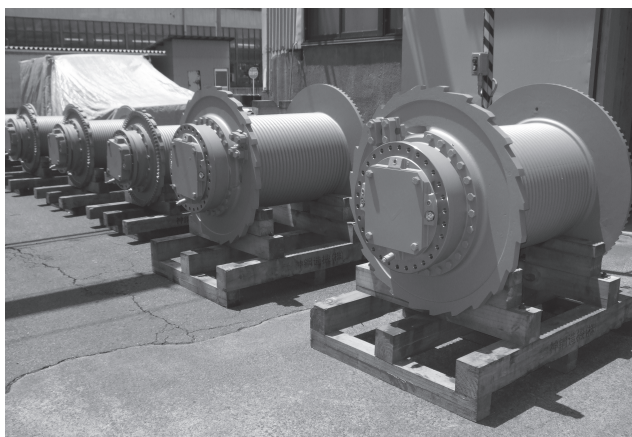
クレーン用ウインチ部分
