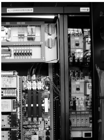
(左から) 出荷を待つハイブリッド切 換装置。同装置の内部。位同期検出 器、停電検出器付き高速マグネッ ト切替器。
