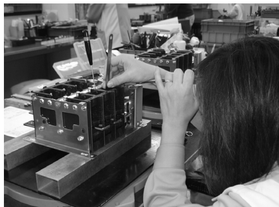
組立・調整中の切換装置
