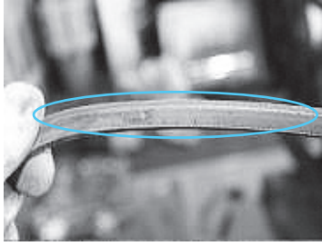
写真6 ファンベルトに亀裂
