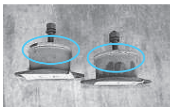
写真4 原動機側防振ゴム剥離
