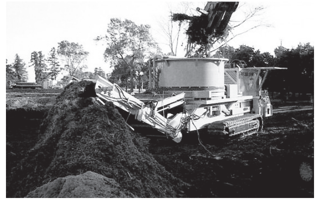
「自走式タブグラインダー TG540TX」 木材や巨木根等を効率的・安全に均一チップ化できる
