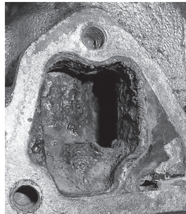
写真8 シリンダヘッド水通路の腐食状況
