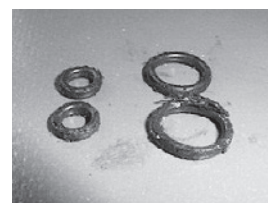
写真11 メインシャフト給・排油管用Oリングにヘタリ有り
