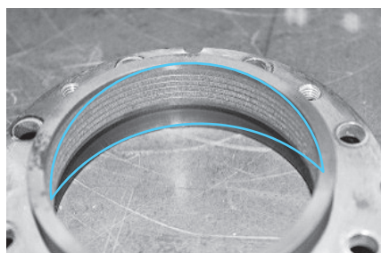
写真12 圧縮機の空気通路部のシール部に極軽微な接触痕有り
