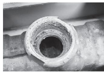
写真12 ラジエータ内冷却水不足
