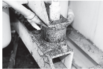
写真7 原動機取付部の防振ゴム
