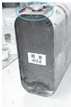
写真9 燃料タンク発錆状況
