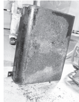
図9 燃料タンクの発錆状況 （外部底面）
