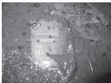
図11 燃料タンク内に堆積したスラッジの状況 （内部底面）
