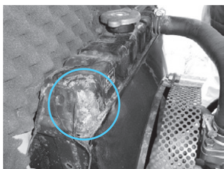
写真6 ラジエータの腐食と亀裂箇所
