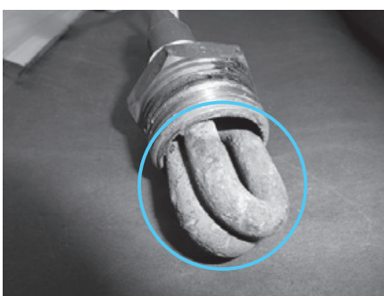
写真7 冷却水ヒータが断線
