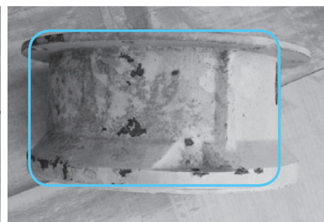
写真11 発電機フロントフレームの汚損
