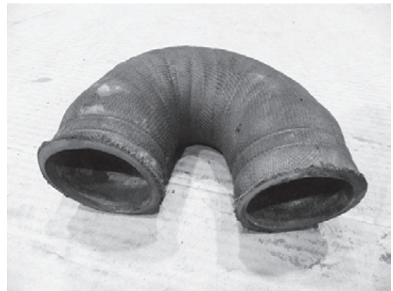
写真29：冷却水ゴムホース外観
