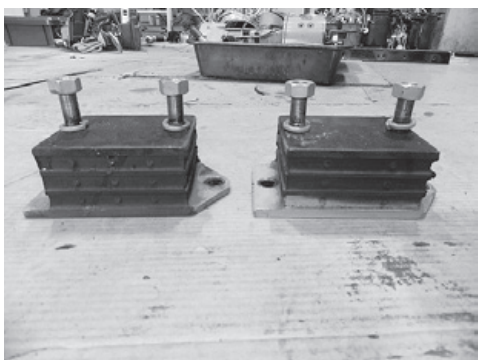
写真4：発電機側防振ゴム
