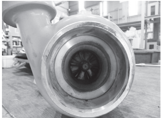
写真25：ターボコンプレッサの汚損
