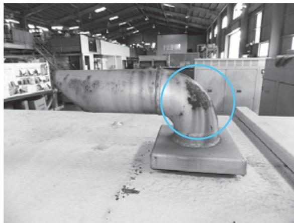
写真23：消音器の排気出口部の発錆
