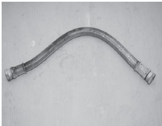
写真22：燃料配管の発錆、汚損
