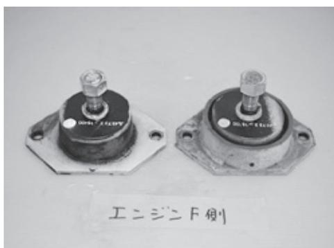
写真4：エンジンフロント側防振ゴム
