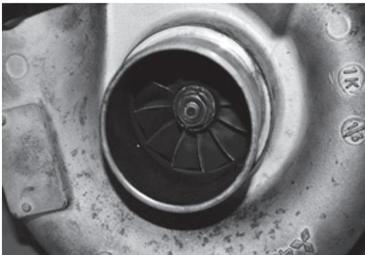
写真8：給気側（コンプレッサ）の汚損
