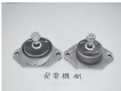
写真5：発電機側防振ゴム
