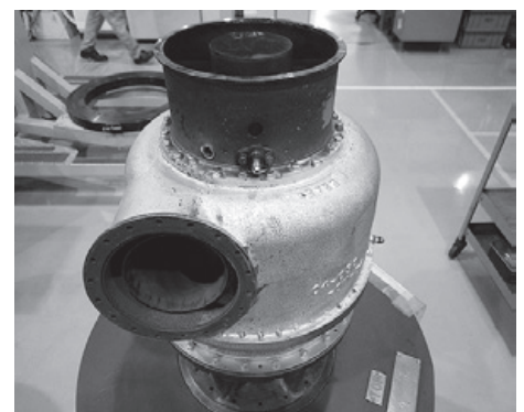
写真2 ガスタービン外観 （燃焼器部分取外し状態）
