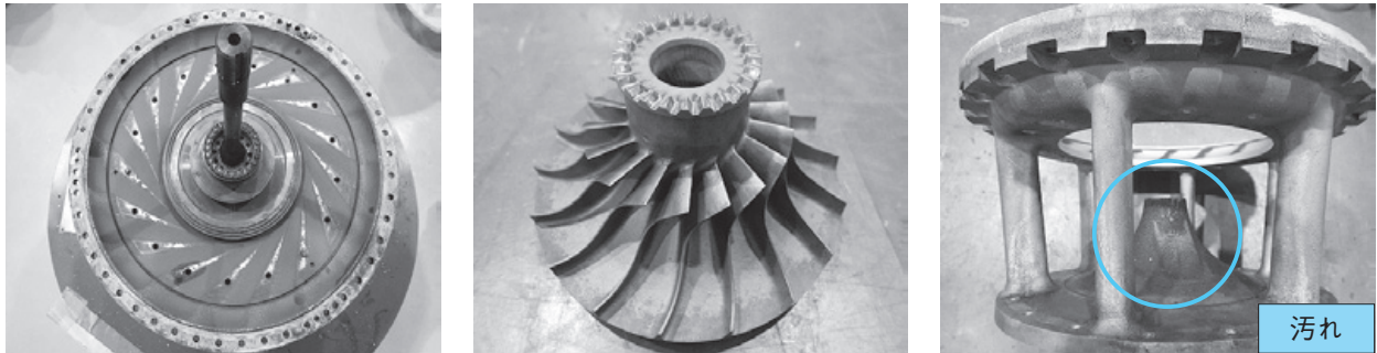
写真4 ガスタービン分解（圧縮機部）
