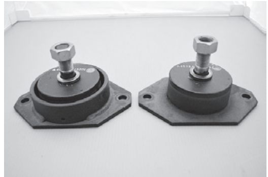
写真5：発電機側防振ゴム
