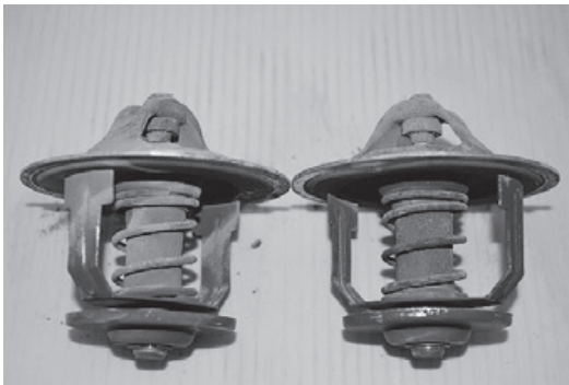
写真31：サーモスタットの発錆及び汚損 (但し、作動確認の結果は異常なし)
