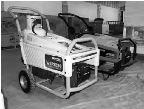
ポータブル・ガスエンジン発電設備 (左) 3.25kW・(右) 5.50kW(单相)
