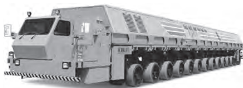
搭載した内燃力発電装置にて電気走行する「ドーリー」
