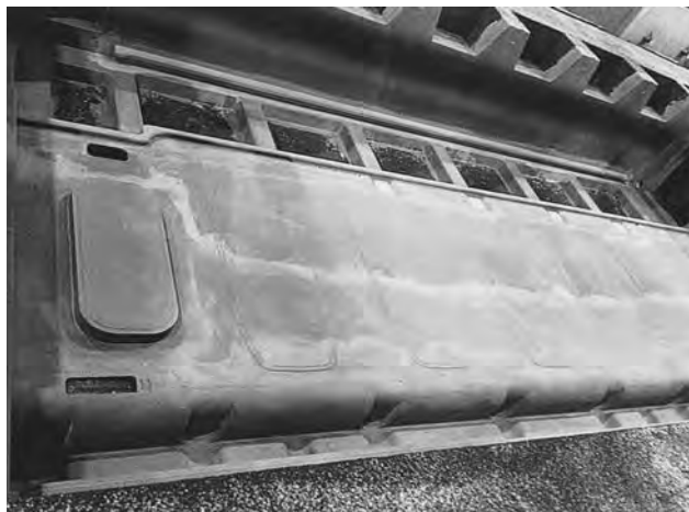
クランクケース主型鑄型（下型）
