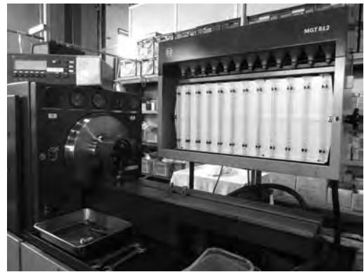
BOSCH社製の燃料ポンプテスターは12気筒まで測定可能
