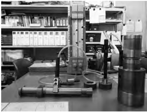
プランジャーの間隙をミクロン単位で計測するエアマイクロメーター
