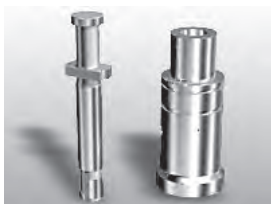
再生修理されたプランジャー（左）とスリーブ（右）
