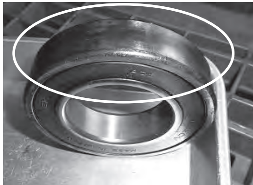
写真2 発電機後端軸受のアウターレース外周部の発錆
