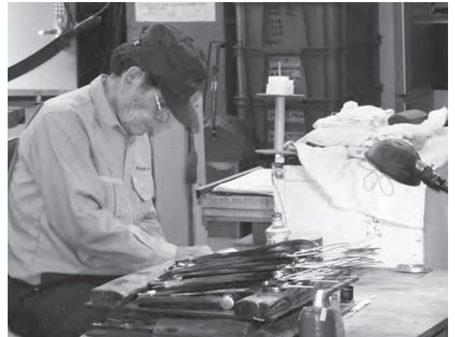
平角形電線の製作作業
