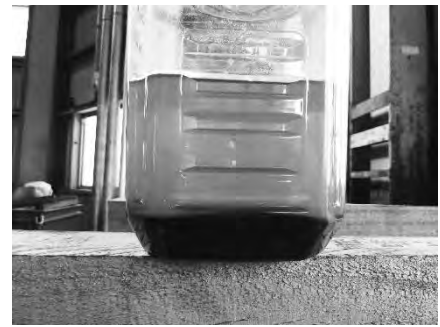
写真2 冷却水の汚損（沈殿物有り）
