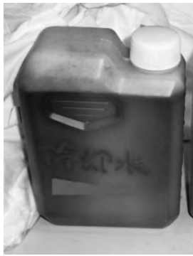
写真1 冷却水の汚損
