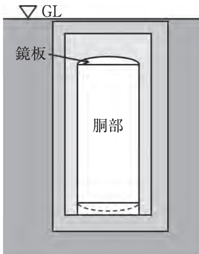
図1 縦置円筒型地下貯蔵タンク
